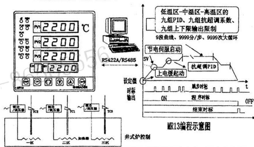
超过三温区的多区控制,可以利用MR13的模拟发送功能,级连的从表[1-24B]置第一回路遥控输入ON,其余回路跟踪第一路的设定值。
