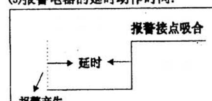
[1-5]窗口设定报警产生后的延时时间: 报警产生后, 在延时过程中, 如果报警条件一直存在, 则报警继电器经延时后动作, 用于可靠的确认报警或延时报警。否则报警被取消。时间: 0~999秒, 设0时, 无延时。
