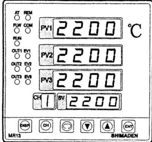
1. PV1-PV3 测量值绿色数码管
