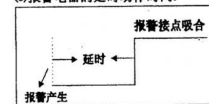
[1-5]窗口设定报警产生后的延时时间:报警产生后,在延时过程中,如果报警条件一直存在,则报警继电器经延时后动作,用于可靠的确认报警或延时报警。否则报警被取消。时间:0~999秒,设0时,无延时。
