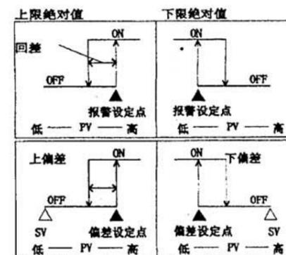
(2)报警回差:(报警动作灵敏度)[1-3]窗口:如报警示意图所示,进/出报警动作值不一致,其差值称为回差,用于避免继电器频繁动作和干扰。MR13的回差值可设,例如,EIDF设为24,则1200℃的回差值24℃。
